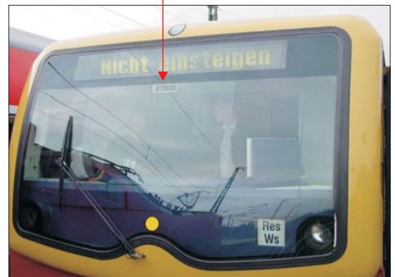
Sehr kleiner Optical Receiver hinter der Frontscheibe
