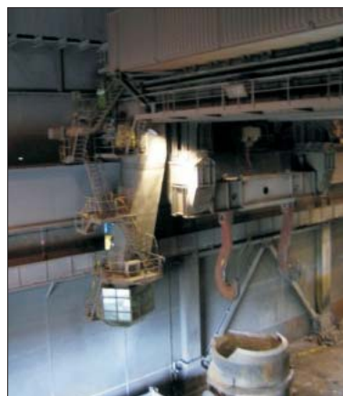
Chargierkran mit INET 100 Übertragungsbereich 1,5 m ... 350 m (Kranbahnlänge)
