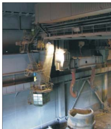
Chargierkran mit INET 100 Übertragungsbereich 1,5 m ... 350 m (Kranbahnlänge)
