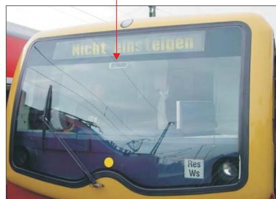
Sehr kleiner Optical Receiver hinter der Frontscheibe
