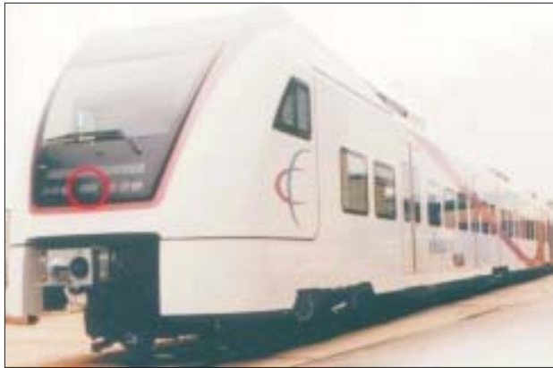
Abb. 5 • Express Rail Link KLIA in Kuala Lumpur IR-Receiver zwischen den Scheinwerfern
