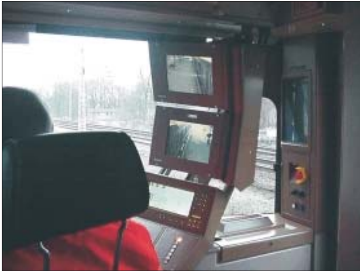
Fig. 2 • S-Bahn Berlin GmbH Ligne S1 cabine du conducteur avec récepteur IR et deux moniteurs TFT (le récepteur est au-dessus du conducteur)
