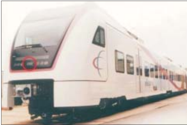
Fig. 5 • Express Rail Link KLIA à Kuala Lumpur Récepteur - IR entre les projecteurs
